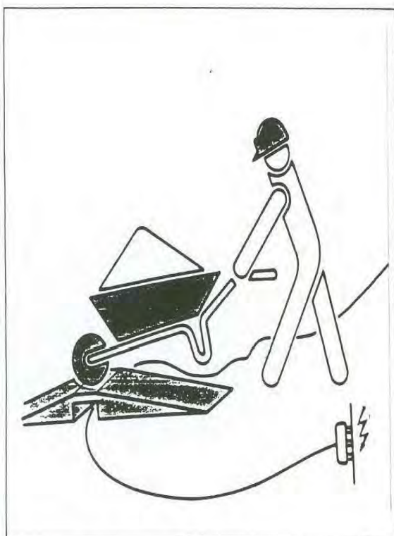
PROTECCION DE CABLES ELECTRICOS
