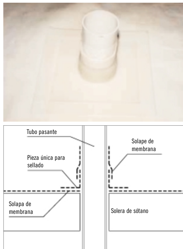
Figura 2.18. Piezas de sellado para paso de conductos. Ejemplo de la empresa Monarflex, Reino Unido
