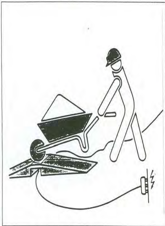
PROTECCION DE CABLES ELECTRICOS
